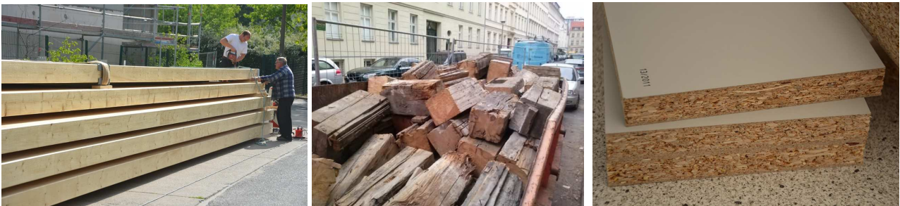
Eine Option der Kaskadennutzung: Bauholz; Altholz; Spanplatten (Fotos: L. Maráz)
